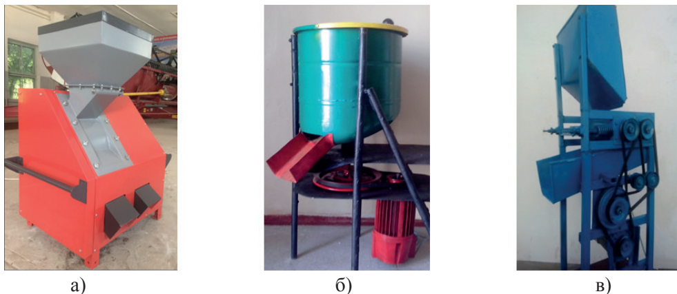
Рисунок 1. Лабораторные молотильные установки а – барабанного типа, б – дискового типа, в – вальцевого типа
