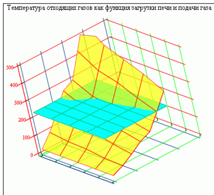
Рис.2 – 2D (двумерная) статическая характеристика печи (желтая поверхность) и уровень оптимальной температуры t = 230^{\circ}\text{C} (голубоватая плоскость).
