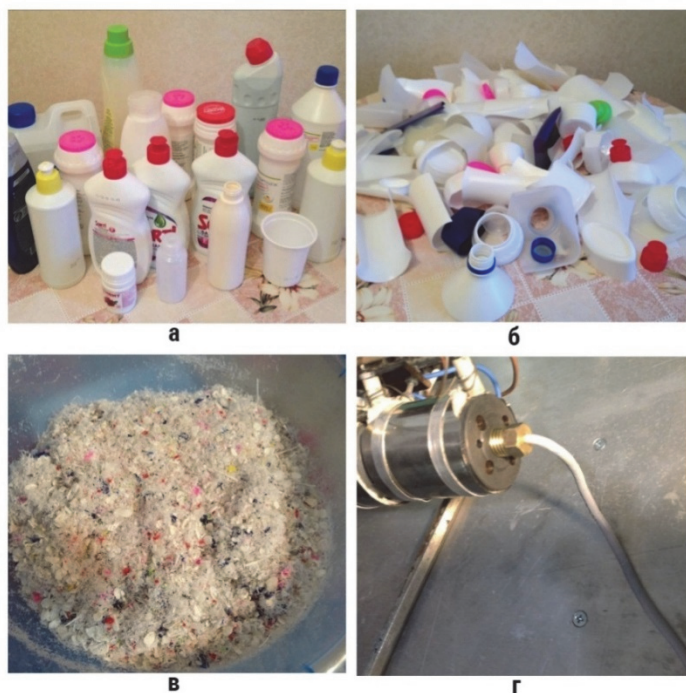
Рис. 1 Этапы получения вторичного полимерного сырья: а - собранные использованные полимерные бутылки, банки и крышечки, б - плоские вторичные полимерные элементы, в - дробленное вторичное полимерное сырье, г – экструзионное оборудование в работе.
