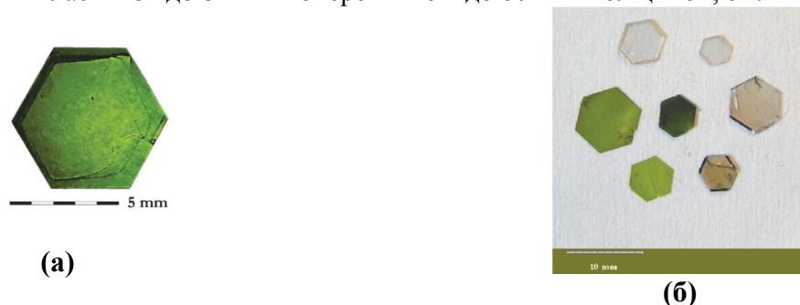
Рис. 1. Синтезированные монокристаллы (а) \text{FeBO}_3 и (б) \text{Fe}_{1-x}\text{Ga}_x\text{BO}_3 с различными x .
