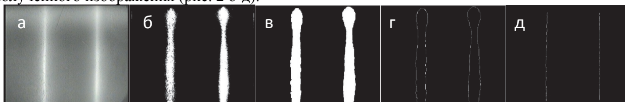
Рис. 2. МО образ линейных дефектов шириной 40 мкм в образце из алюминия ( f = 30 кГц, H_{\sim} = 16 Э): исходный (а), улучшенный применением эрозии и наращивания (б, в), после морфологических операций удаления внутренних пикселей (г) и утоньшения образа (д).
